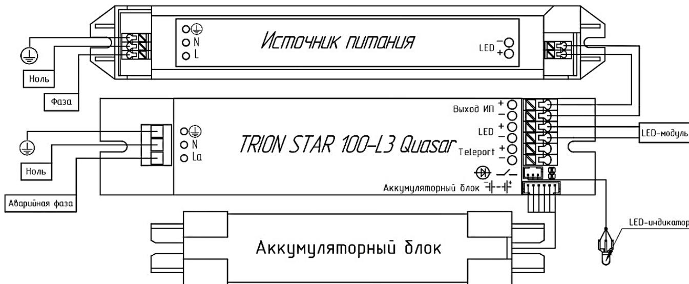
Рисунок 2 – Схема подключения БАП
